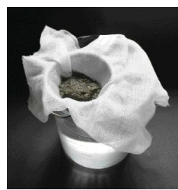
凝集フロックは非常に 大きく粘性が無いため 脱水性に優れています。
