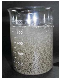
薬剤を投入・攪拌。 フロックが一気に成長 します。
