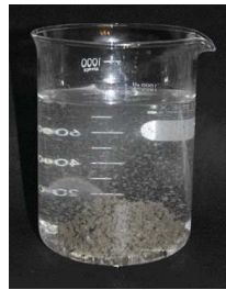
攪拌停止。 フロックが沈殿します。 この間わずか10秒。
