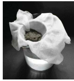
凝集フロックは非常に 大きく粘性が無いため 脱水性に優れています。
