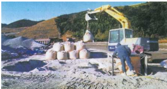
①CAS-42(粉体)をフレコンバッグに充填します。
